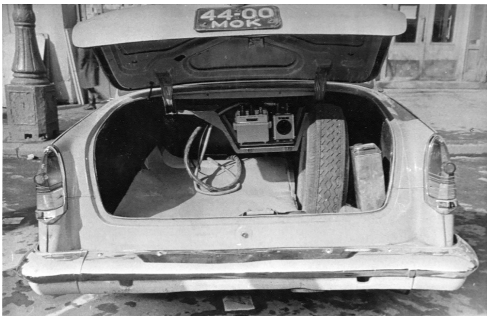
Установка приемопередатчика и блока питания в багажнике «Волги»
